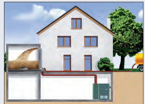
Beispiel: Vom Heizraum entfernter Lagerraum – Transport der Pellets mit HDG Pellet-Saugsystem
